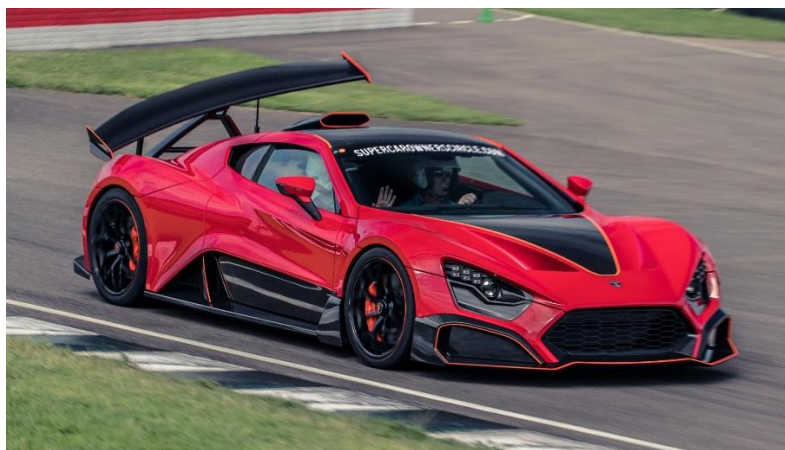
9 pav. „Zenvo TSR-S“ automobilis turintis asimetriškai reguliuojamą galinį sparną [24]
