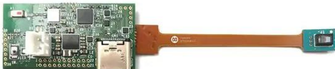
7 pav. MAXM86161EVSYS eksperimentinis maketas: kairėje - biometrinių duomenų apdorojimo valdiklis MAX32664, dešinėje - optinis jutiklis MAXM86161
