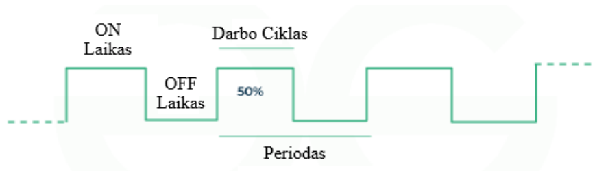
1.16 pav. PWM dažnis [27]
