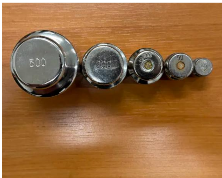
5.2 pav. Naudoti etaloniniai svareliai svorio jutiklių kalibravimui
