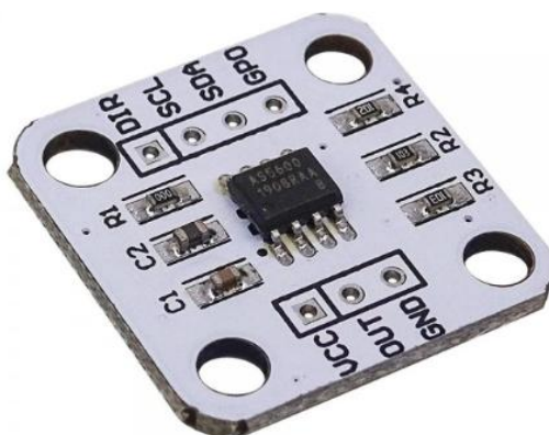
3.8 pav. AS5600 magnetinis kampo jutiklis [39]
