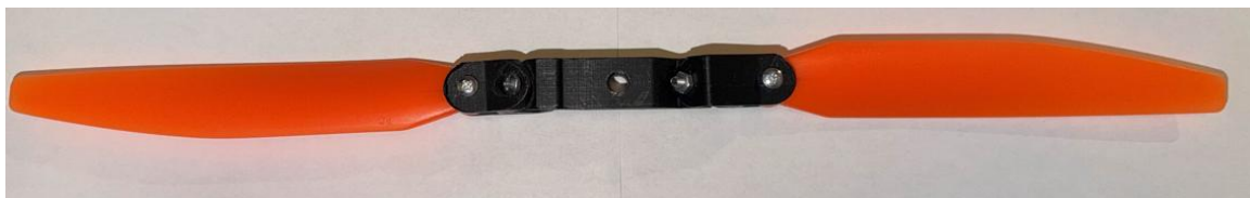
2.6 pav. Surinktas propelerio mechanizmas su lanksčiais mentės tvirtinimo mazgais
