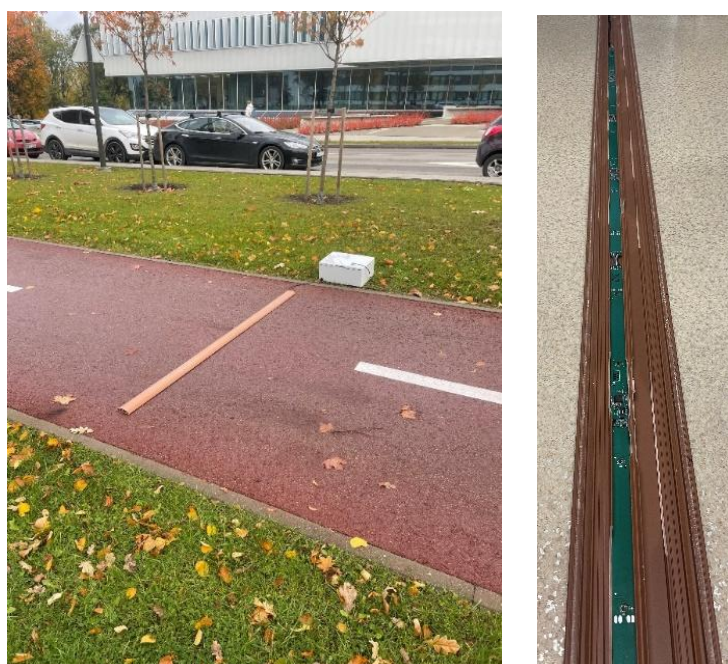
28 pav. Duomenų surinkimo sistema (kairėje) ir jutiklių gardelė (dešinėje), naudota eksperimento metu
