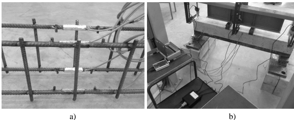
2.9 pav. Armatūros deformacijų matavimo jutikliai: a) įrengimas; b) prijungimas prie matavimo įrangos
