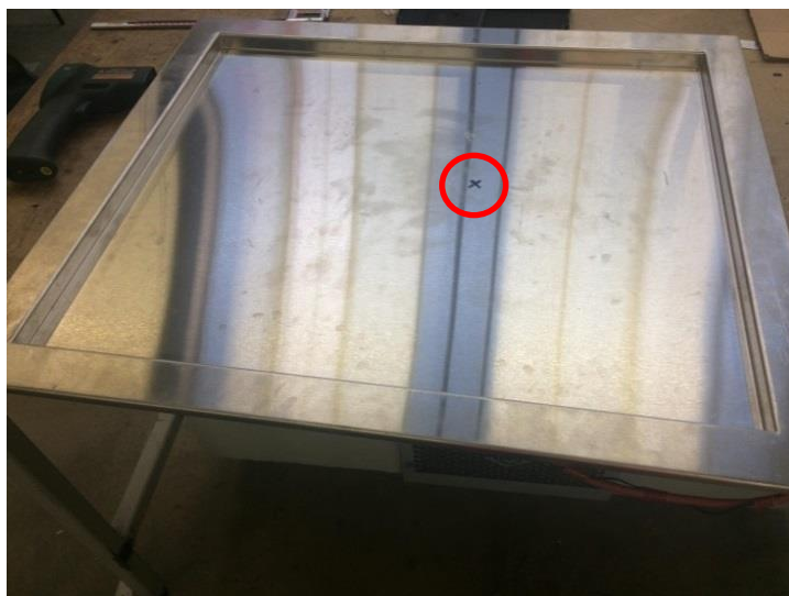
27 pav. Maisto ruošimo šildomo paviršiaus UWP1 šiluminių deformacijų matavimo kontrolinis taškas
