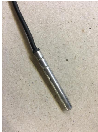
26 pav. Daugiakanalio temperatūros ir slėgio duomenų registratoriaus Eliwell Memory 1000 sensorius
