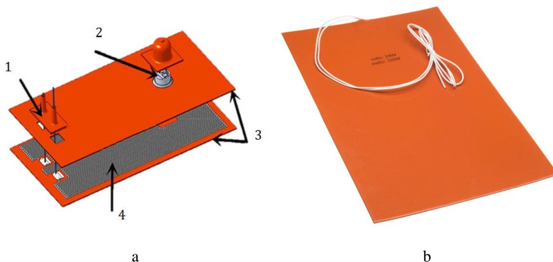
16 pav. a – kaitinimo kilimėlio komponentai: 1 – maitinimo laidas, 2 – termostatas, 3 – silikono sluoksnis, 4 – kaitinimo elementas; b – kaitinimo kilimėlis [21, 22]
