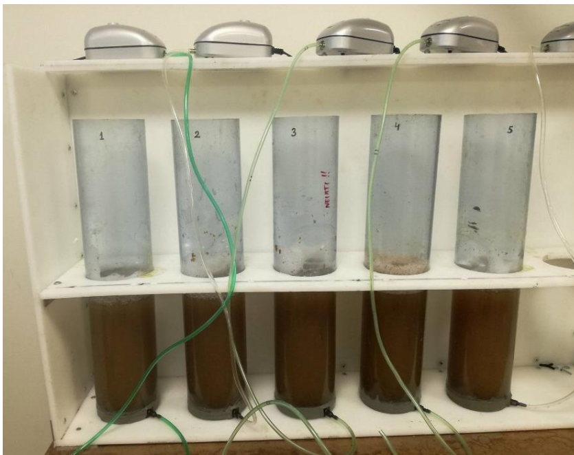
4 pav. Tyrimui naudota biologinio valymo sistema
