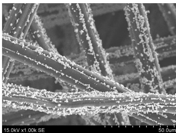
3.23 pav. Maišymo reaktoriuje teigiamai poliarizuotų GV elektrodų (viršuje bandymas Nr. 2, apačioje bandymas Nr. 3) išorės (kairėje) ir vidaus (dešinėje) SEM nuotraukos.
