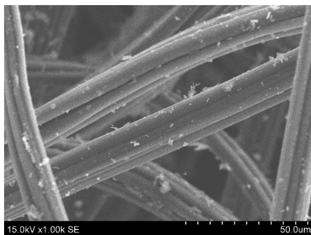
3.24 pav. Pratekančiame reaktoriuje teigiamai (kairėje?) ir neigiamai (dešinėje?) poliarizuoto GV elektrodo (bandymas Nr. 2) vidaus SEM nuotraukos.
