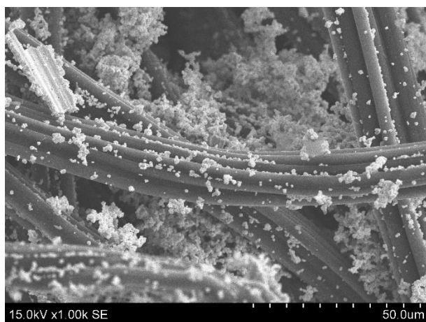
3.24 pav. Pratekančiame reaktoriuje teigiamai (kairėje?) ir neigiamai (dešinėje?) poliarizuoto GV elektrodo (bandymas Nr. 2) vidaus SEM nuotraukos.
