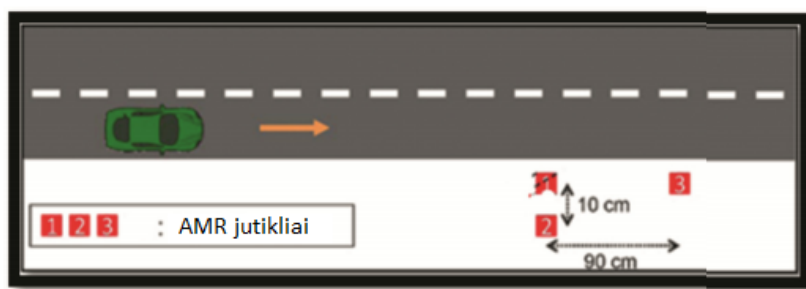
19 pav. Jutiklių išdėstymo schema transporto priemonės greičio ir parametrų nustatymui.
