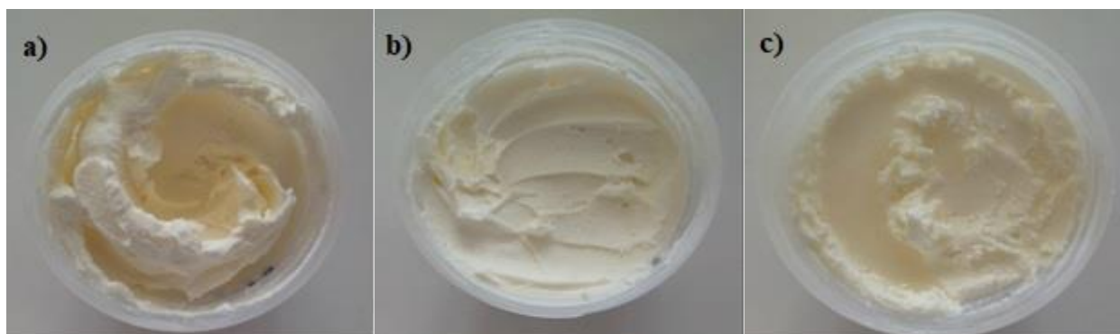
8 pav. Dvigubosios emulsijos su skirtingais vandens ir aliejaus fazės svorių santykiais: a) V_1/A (30:70) ir V/A/V (50:50); b) V_1/A (40:60) ir V/A/V (60:40); c) V_1/A (50:50) ir V/A/V (70:30).
