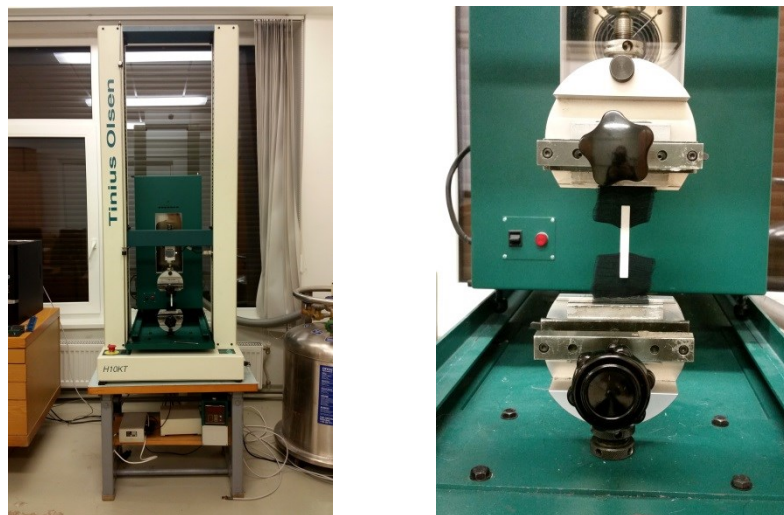
2.3 pav. Tempimo bandymas: a) „Tinius Olsen H10KT“ tempimo mašina; b) kombinuotos sistemos tvirtinimas spraustuvuose
