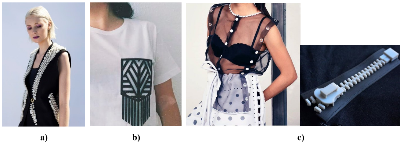
1.13 pav. 3D objektų tvirtinimas prie tekstilės medžiagų: a) priklijuojant [33]; b) prisiuvant [34]; c) tiesiogiai užspausdinant [35];
