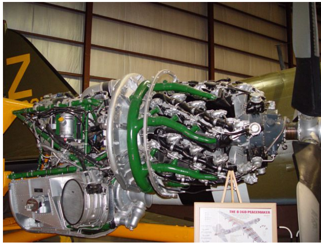
3.pav. 3.2MW galios stūmoklinis variklis R4600 [31]
