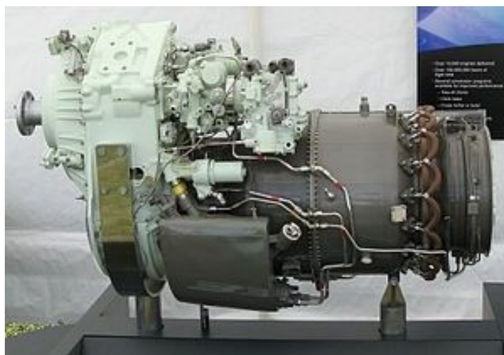
8.pav. Turbo sraigtinis variklis TFE – 331 [28]
