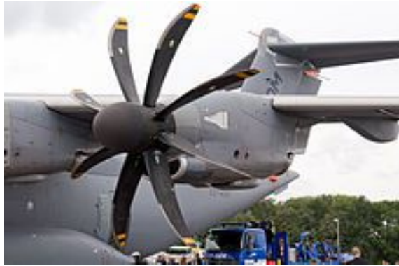
6.pav. Vienas iš 4-ių lėktuvo A - 400 variklių TP – 400[27]
