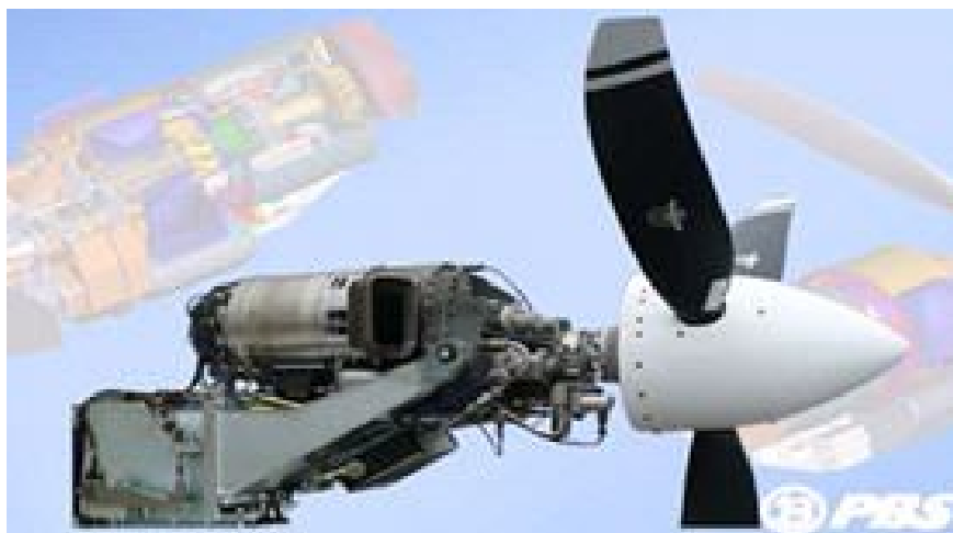
11.pav. Mažagabaritis turbo sraigtinis variklis PBS TP100 [24]
