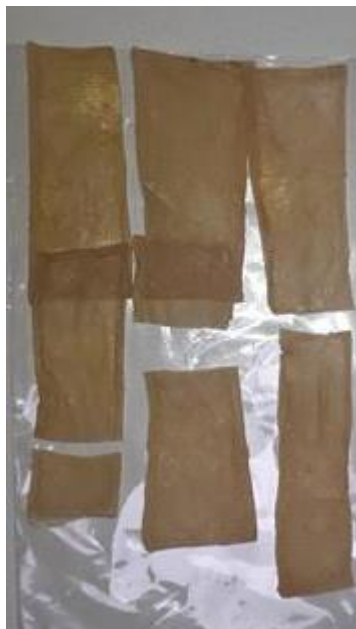
26 pav. 75 °C temperatūroje džiovintų bandinių junginių po šlyties tempimo eksperimento vaizdai
