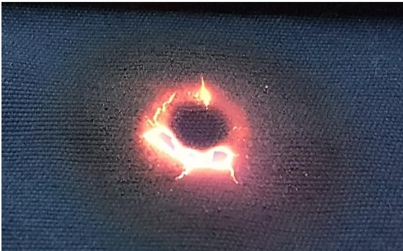
9 pav. Ugnies skverbimasis per įtrūkimo vietas
