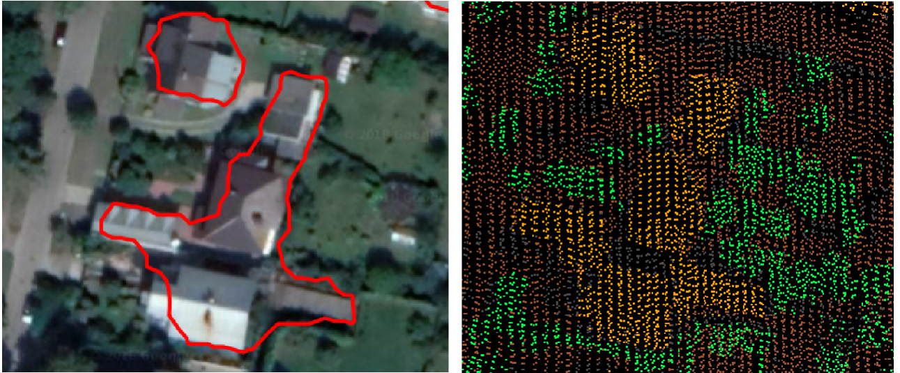
28 pav. „Alpha Shapes“ algoritmo klaida esant dideliam slenksčiui
