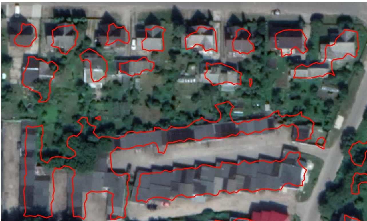
37 pav. Išgautos pastatų kraštinės taikant „Alpha Shapes“ algoritimą
