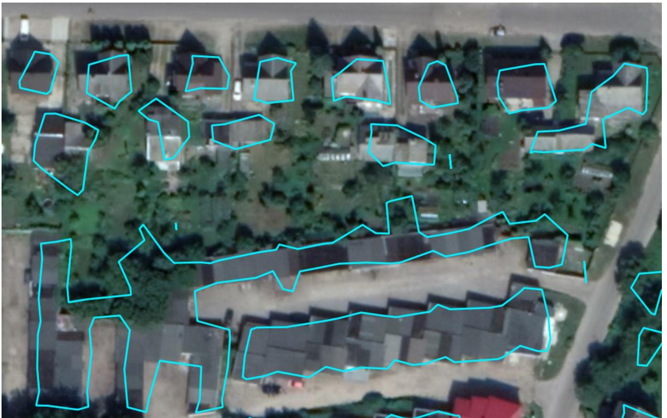
39 pav. Normalizuotos pastatų kraštinės taikant Guru „cornerity“ indekso algoritmą
