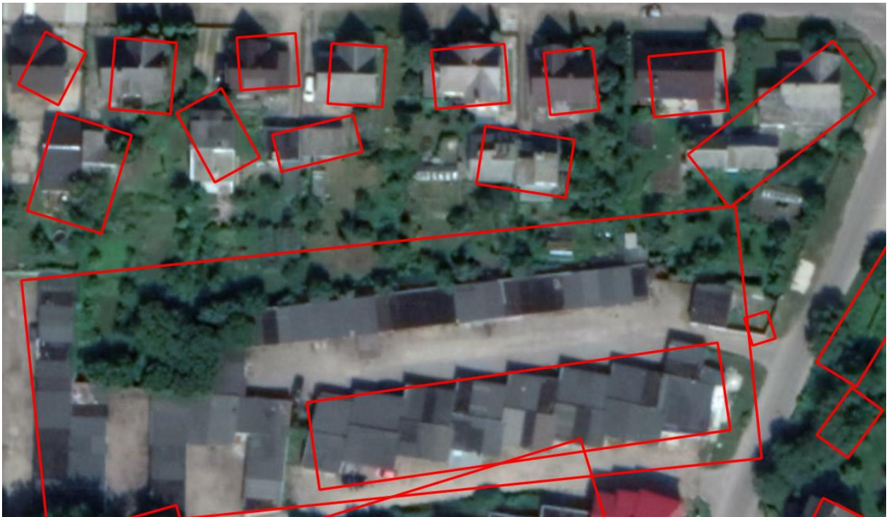
35 pav. Išgautos pastatų kraštinės mažiausio ploto stačiakampio algoritmu
