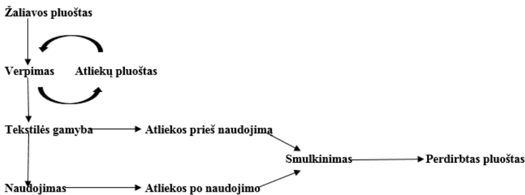
1.4.3.2 paveikslas. Mechaninio tekstilės perdirbimo schema. Šaltinis: Saint – Hyacinthe, Quebec, 2013.
