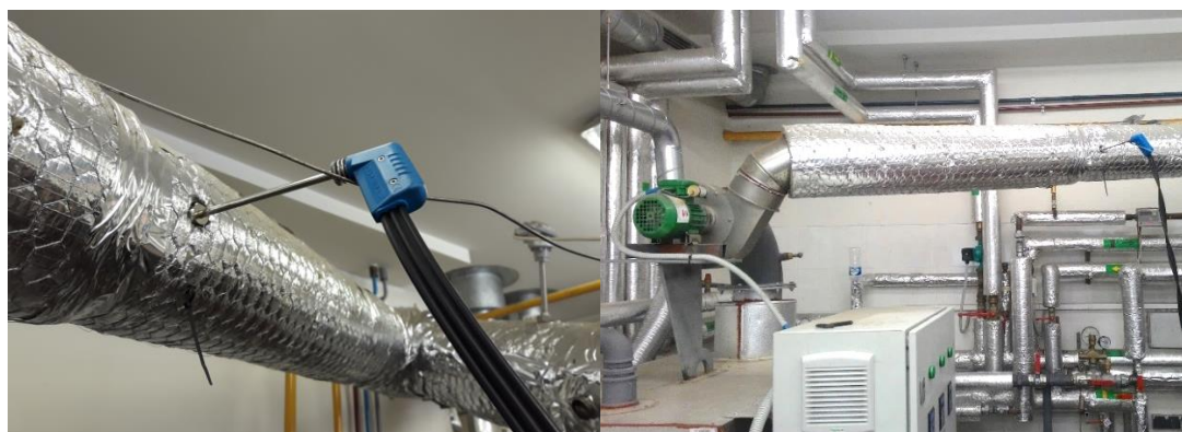
2.6 pav. Dūmų analizatoriaus matavimo taškas iš katilo išeinančių dūmų sudėties matavimams.
