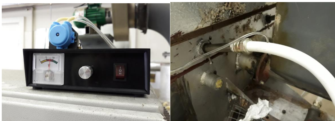
2.2 pav. Sistema, skirta reagento dozavimui.
