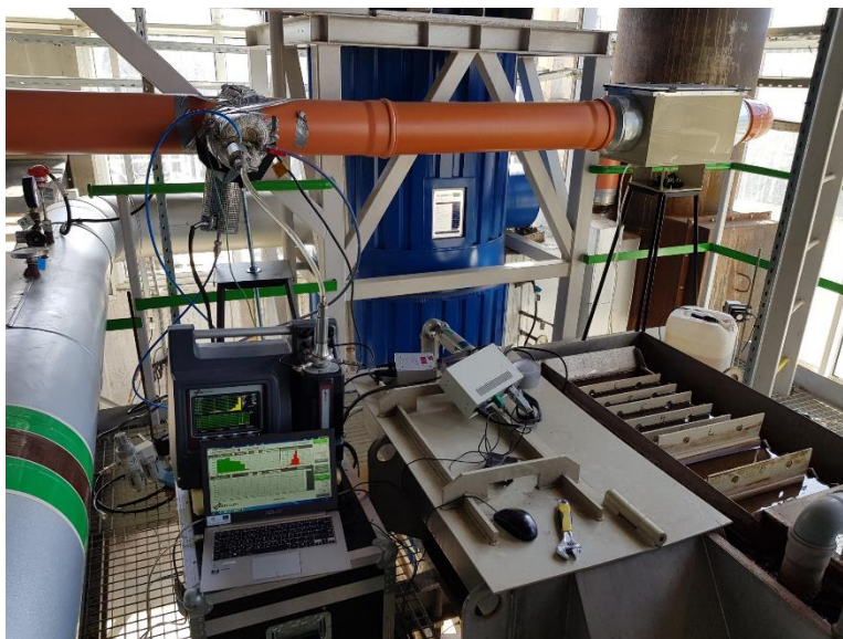
37 pav. Biokuro katilinėje atliekamas sukonstruoto lašelių separatoriaus stendo bandymas.
