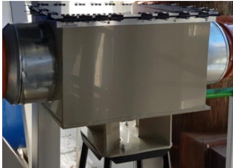
34 pav. Aerodinaminis lašelių separatorius
