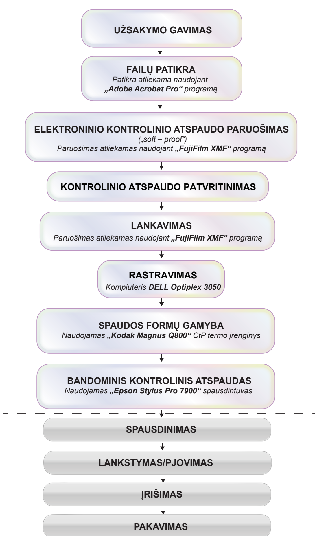
28 pav. Brošiūrų paruošimo spaudai ir gamybos technologinio proceso schema
