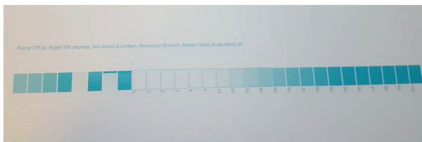
18 pav. Nekalibruota procentinė skalė ant spaudos formos (175 lpi)
