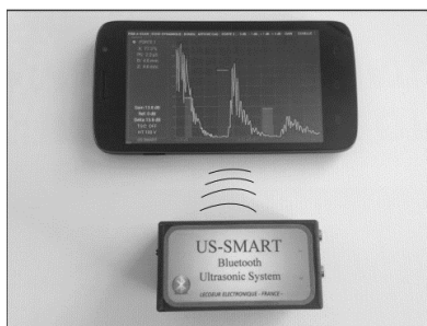
1.17 Pav. Bevieliu ryšiu komunikuojanti US.Smart ultragarsinė duomenų surinkimo sistema [17].
