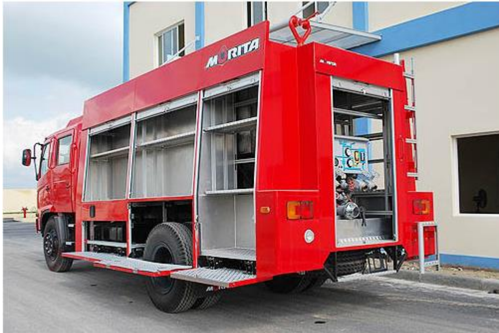
1.4.6 pav. Japonų gamintojo automobilis, padengtas išformuotomis stiklo pluošto panelėmis [13]
