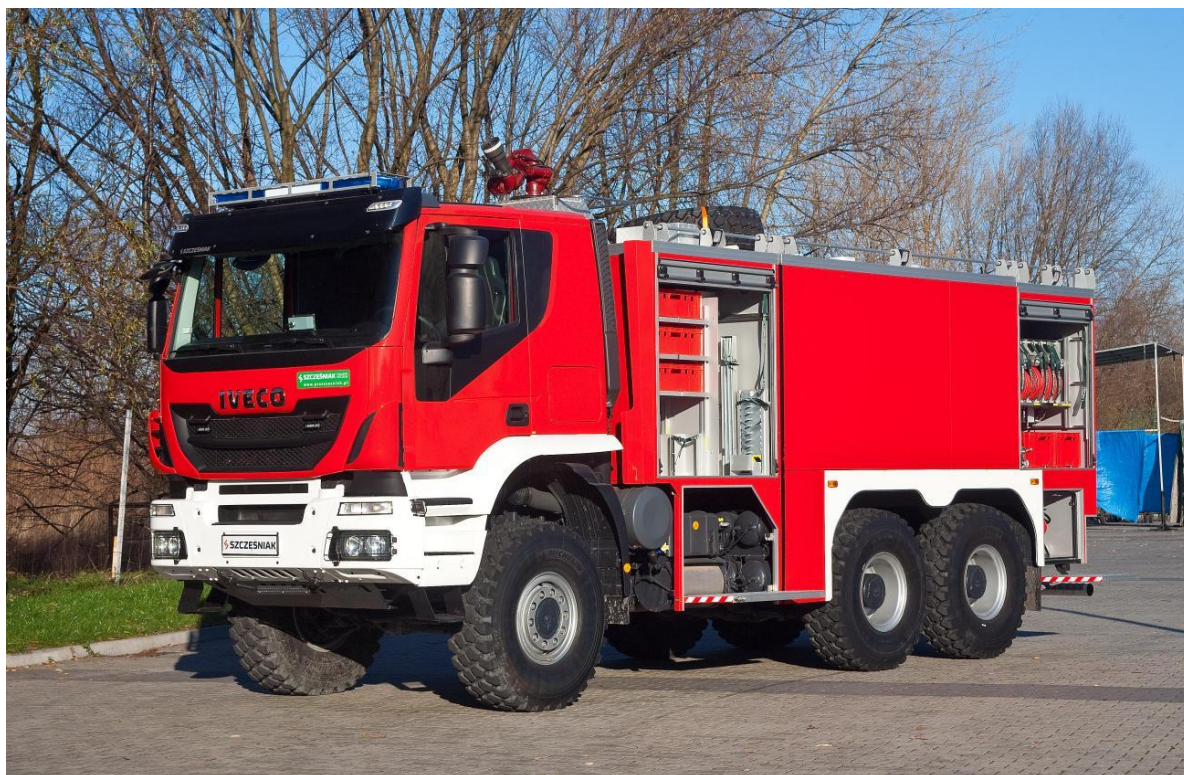
1.4.1 pav. UAB „Szczesniak“ įmonės pagaminta autocisterna ant IVECO važiuoklės [11]
