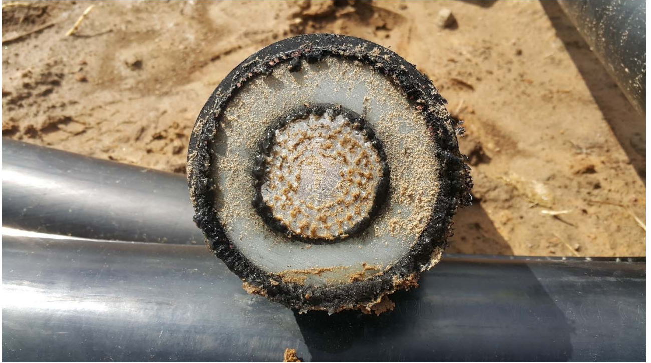
12 pav. „NordBalt“ kabelio išpjova palikta drėgmėje
