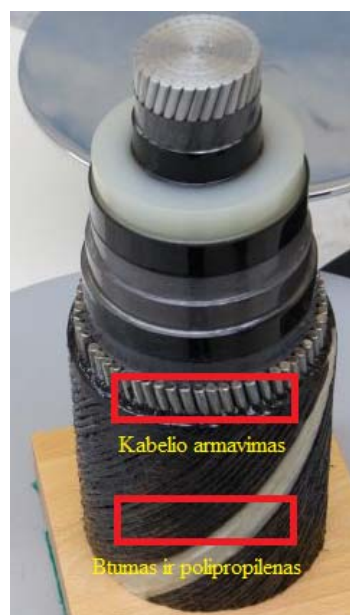
14 pav. Kabelio apvalkalas ir armavimas
