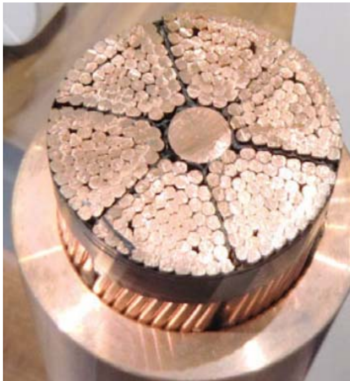
9 pav. „Milliken“ tipo laidininkas
