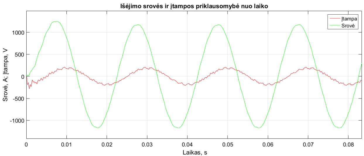
5.2.4 pav. Išėjimo srovės ir įtampos priklausomybė nuo laiko (su MC filtrais).
