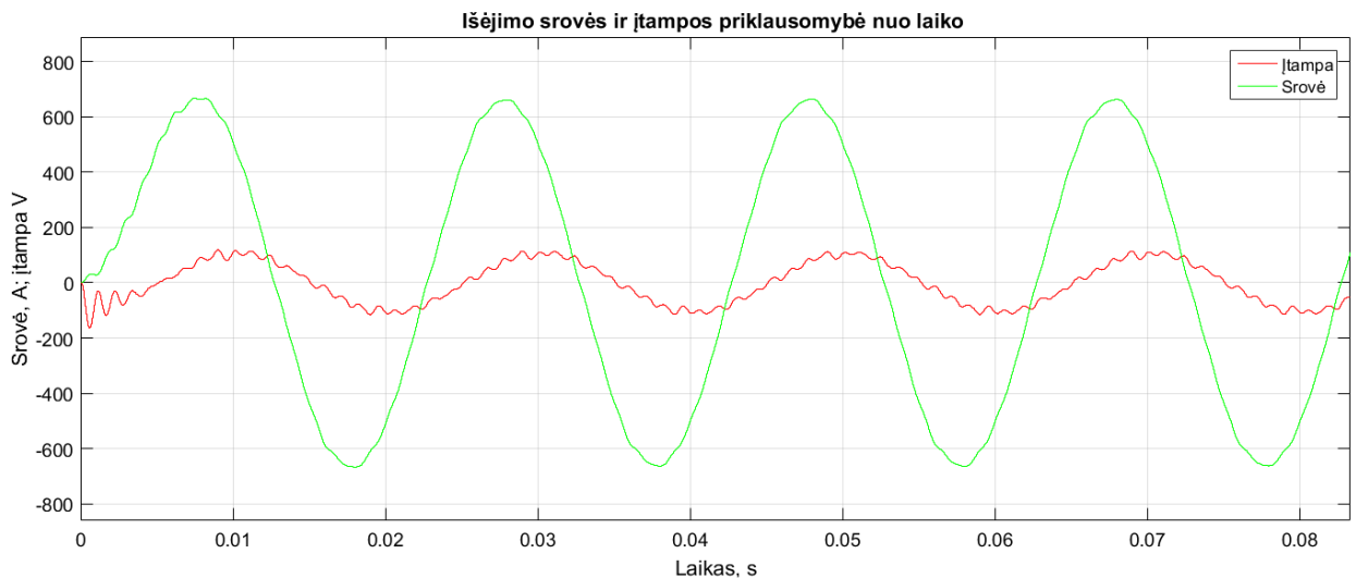
6.7 pav. Išėjimo srovės ir įtampos priklausomybė nuo laiko, kai \Phi_{reg}=0^\circ , U_a=\sqrt{3}/\sqrt{2}/\sqrt{3} .
