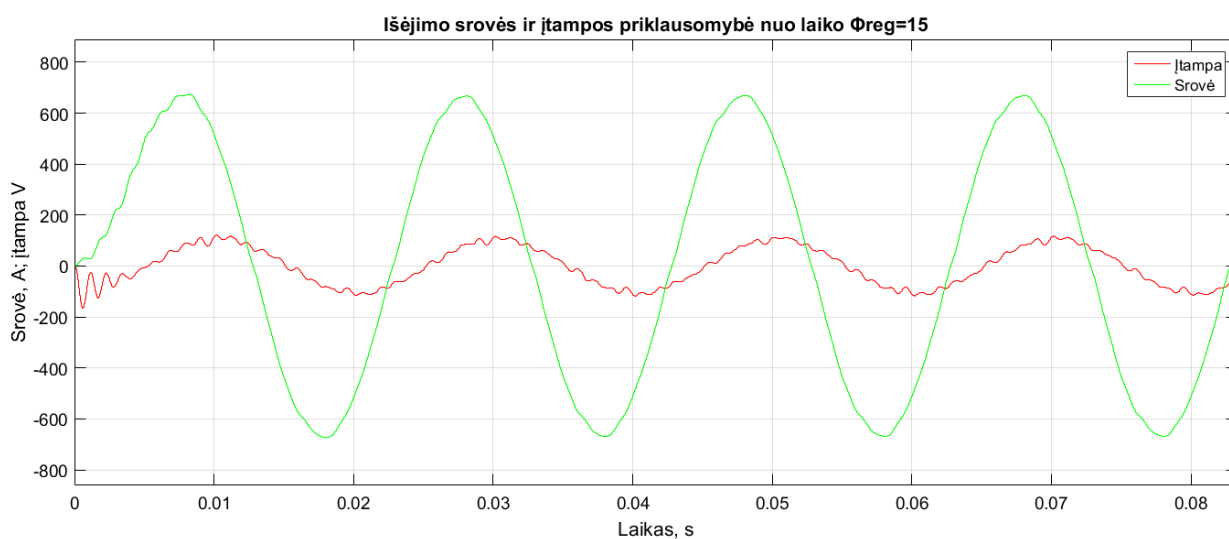
6.9 pav. Išėjimo srovės ir įtampos priklausomybė nuo laiko, kai \Phi_{reg}=15^\circ , U_a=\sqrt{3}/\sqrt{2}/\sqrt{2.9} .
