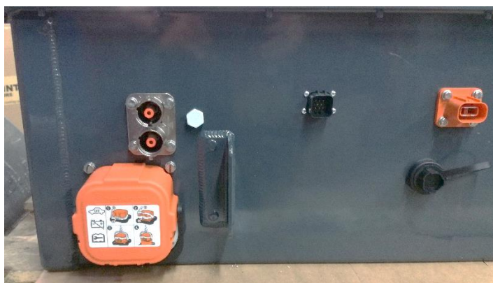
3.7.2 pav. Sistemos aptarnavimo atjungėjas ir aukštos įtampos galios jungtis.
