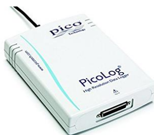
27 pav. Tyrimams atlikti naudojama analogas-kodas 24 bitų rezoliucijas keitiklis - „PicoLog24“
