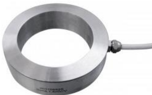
28 pav. Tyrimuose naudotas žiedo tipo dinamometro jautrusis elementas
