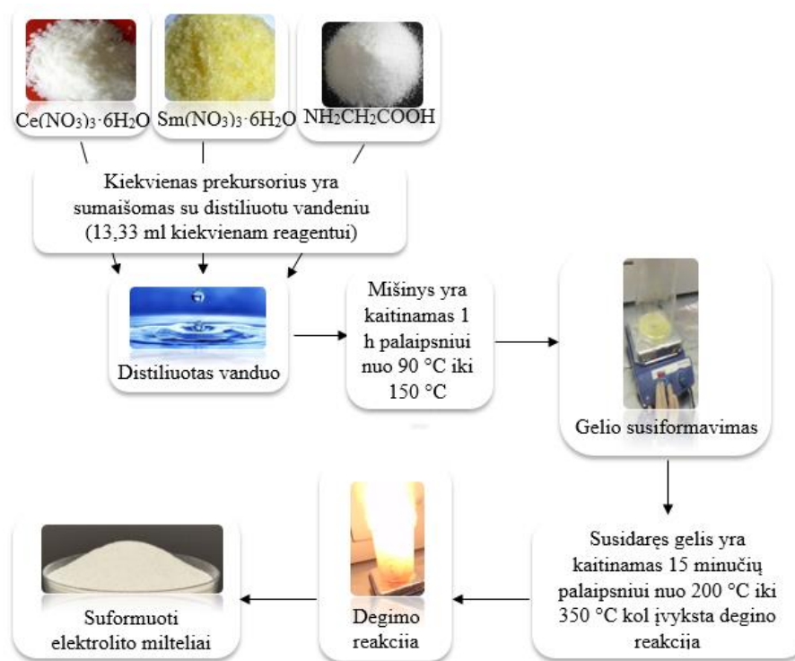
2.1.2.1 pav. Cerio oksido miltelių, modifikuotų samario oksidu, formavimo glicino nitrato išdeginimo būdu schema
