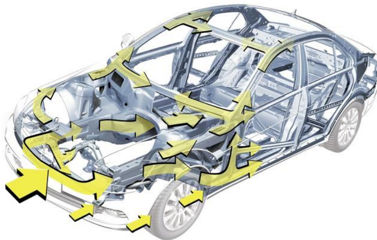
1.1 pav. Smūgio energijos pasiskirstymas automobilio kėbule [1]
