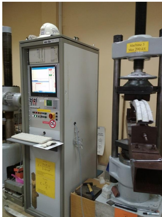
3.1 pav. Buferio sijos lenkimo eksperimento eiga
