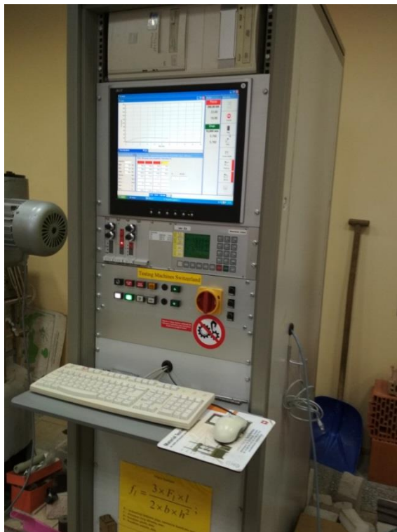
2.13 pav. Hidraulinis presas Walter bai ag
