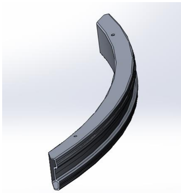
2.2 pav. VW Passat apsauginės sijos 3D modelis
