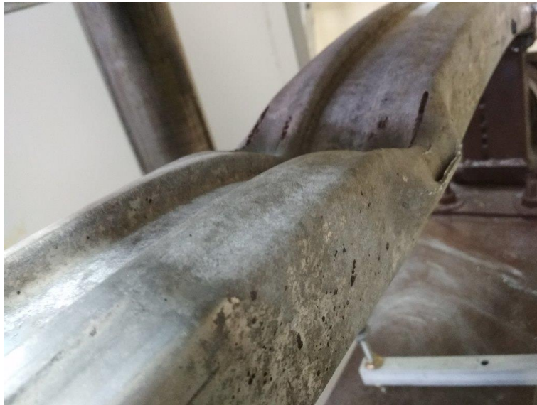
3.12 pav. Suirusi buferio sijos konstrukcija po pakartotinio lenkimo
