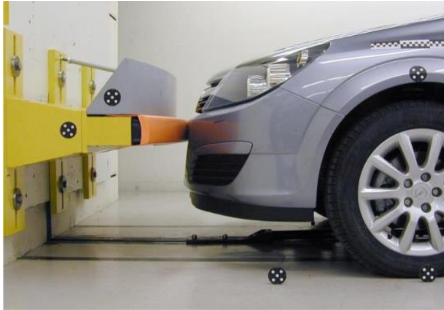
1.4 pav. Buferio sijos testas, įvertinama žala automobiliui [6]
