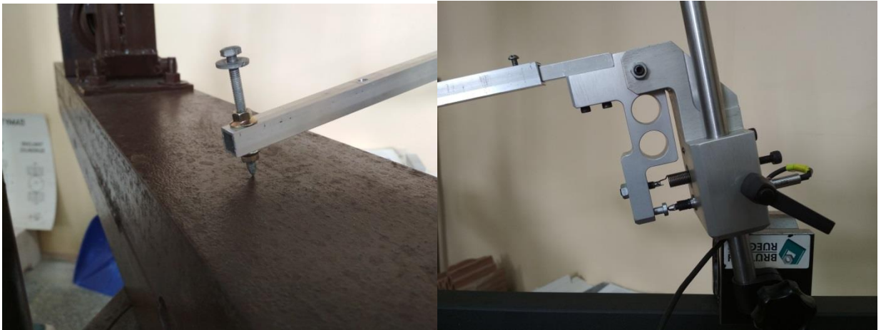
2.15 pav. Eksperimentui pritaikytas poslinkio matuoklis
