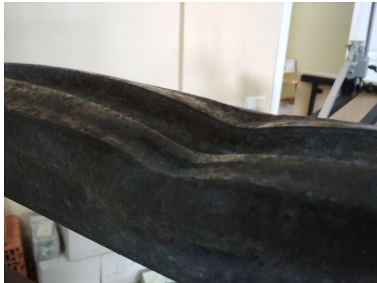
3.3 pav. 50 mm lenkimo bandymo rezultatas
