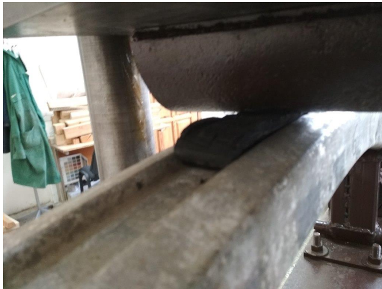
3.8 pav. Apkrovos pridėjimo vietoje panaudotas gumos sluoksnis
