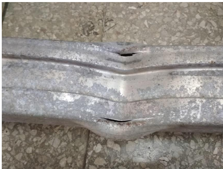
3.7 pav. Plyšiai buferio sijos konstrukcijoje
