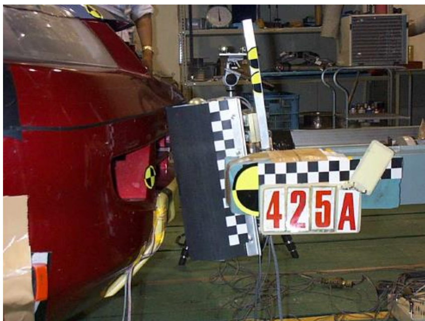
1.3 pav. Buferio sijos tyrimas susidūrimo su pėsčiuoju atveju [5]
