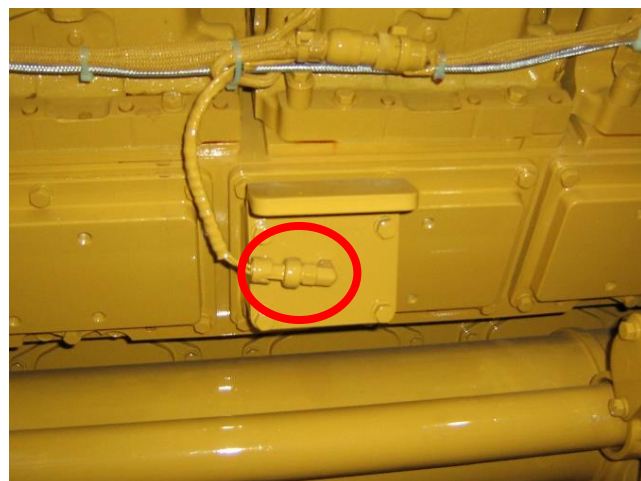
13 pav. Karteryje esančio slėgio jutiklis
