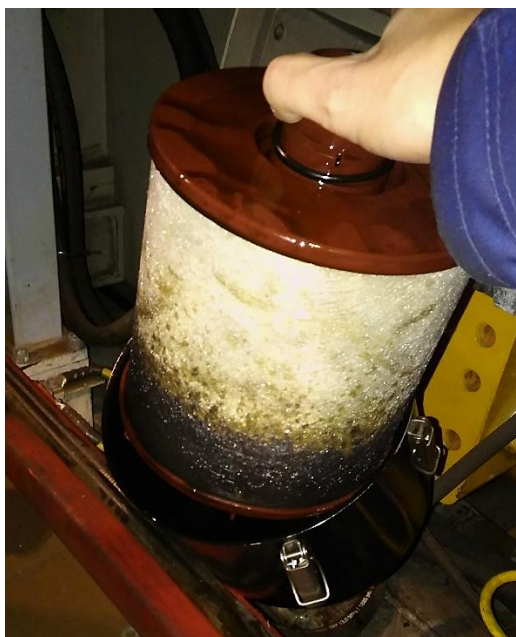
34 pav. Karterio dujų alsuoklio filtras užterštas varikline alyva
