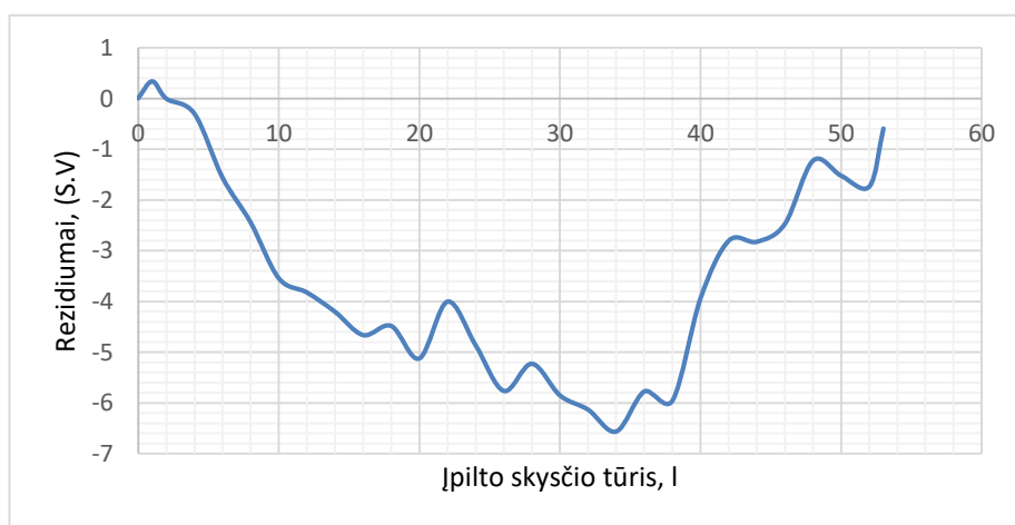
3.36 pav. Eksperimentiniu būdu nustatyto įpilto skysčio kiekio reziduumai nuo praktinio skysčio kiekio talpoje
