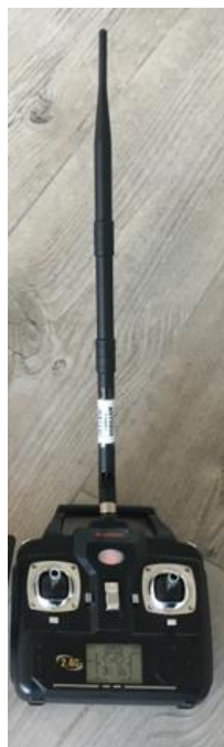
30 pav. Patobulintas valdymo pultas su 9 dBi antena
