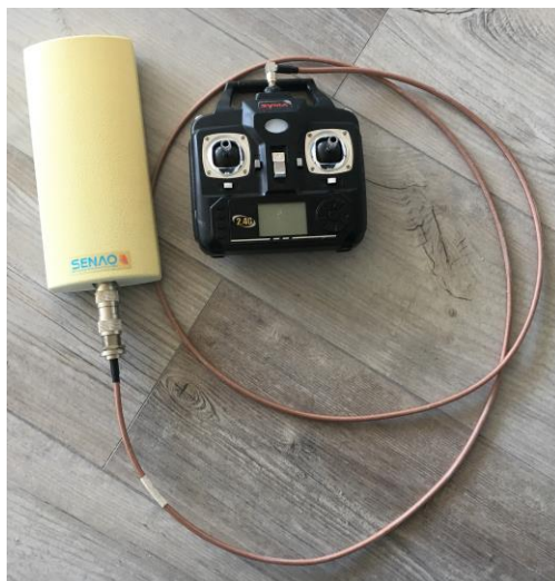
31 pav. Patobulintas valdymo pultas su 12 dBi antena
