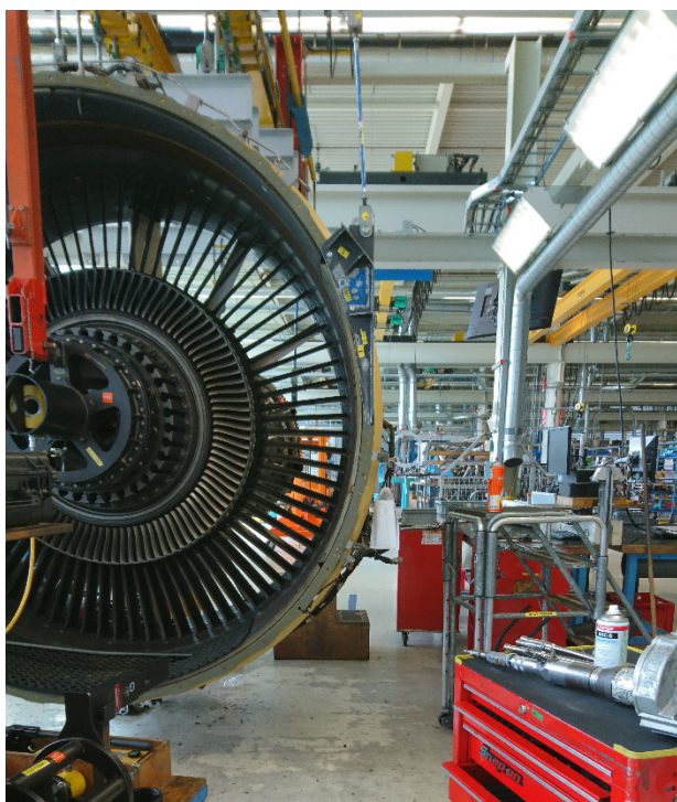
2.1 pav. Pritvirtinto hidraulinio preso prie žemo slėgio kompresoriaus pagrindinio disko skirtos turbinos ir veleno atjungimui praktinis pavyzdys.
