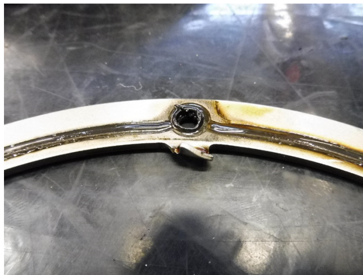
1.17 pav. Pavyzdys-1. Pažeistas guolio veržlės tarpinis žiedas su užraktu.
