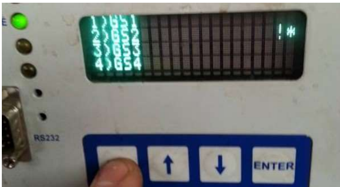
16 pav. Neveikiančio dažnių keitiklio išraiška diagnostinėje panelėje
