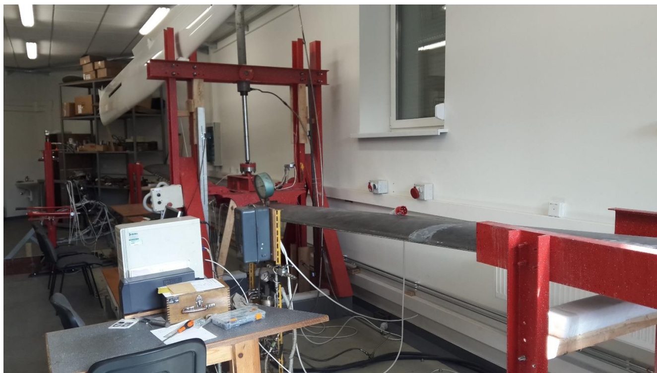
2.1 pav. Ilgaamžiškumo bandymo stendas su bandomuoju sparnu
