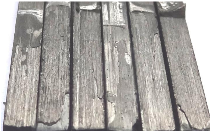
2.19 pav. Suirusių nuovargio bandinių vaizdas [21]
