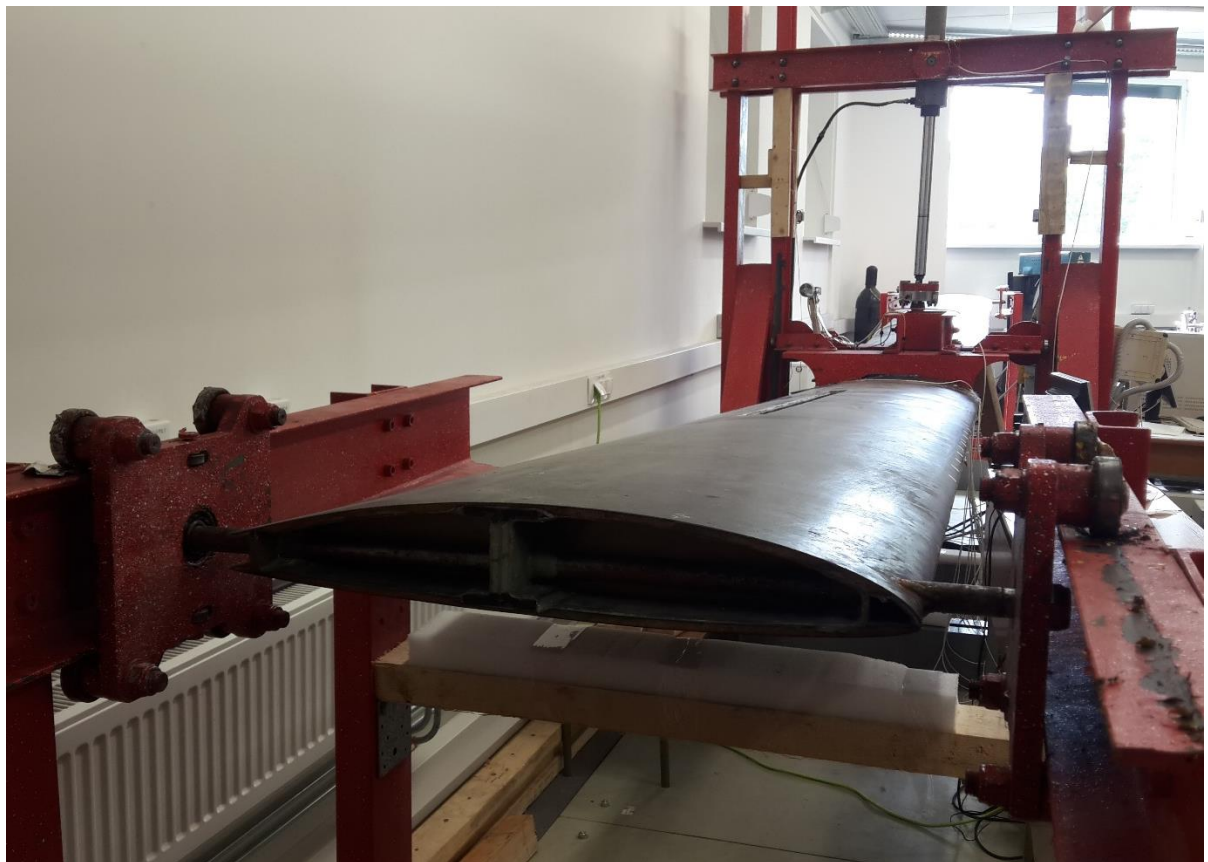
2.3 pav. Šarnyrinis sparno galo tvirtinimas stende
