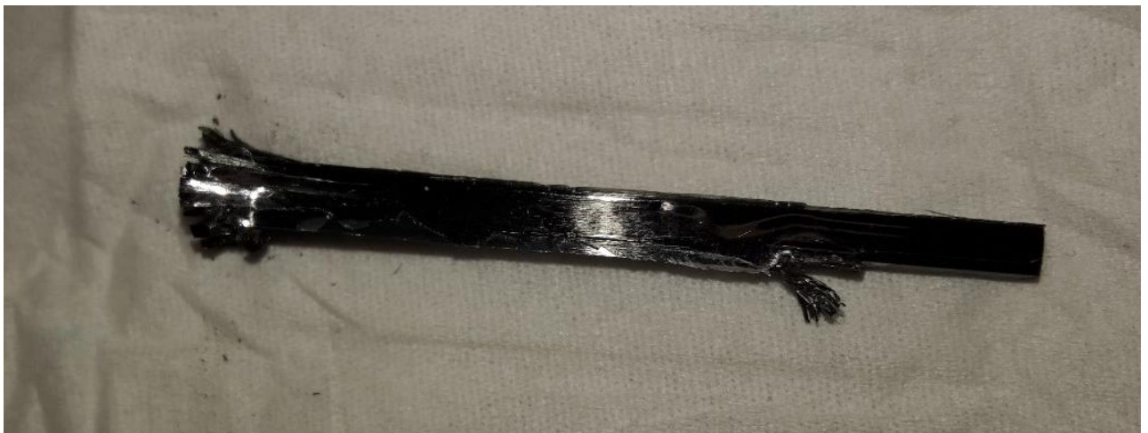
2.14 pav. Bandinys su bandymo metu nuglemžtu trumpesniuojų strypeliu
