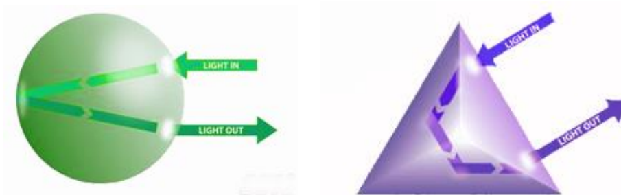
7 pav. Stiklo rutuliuko ir prizmės šviesos atspindėjimo schema [7]
