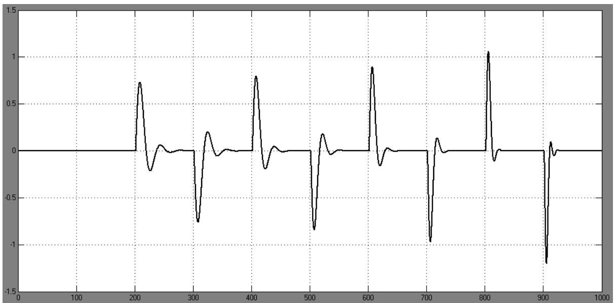
3.14 pav. Tiriama proceso modelio su kintančia proceso laiko pastoviąja T_{pr} (20-4) reguliavimo sistemos pereinamieji procesai.
