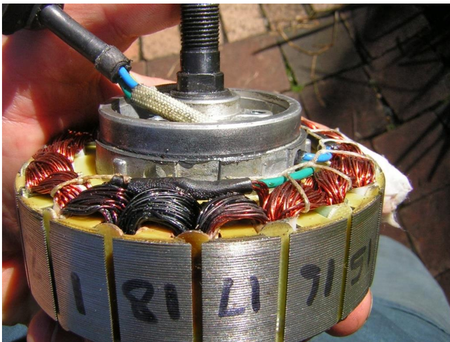
1.3.2 Pav. Sudegusi BNS variklio apvija dėl trumpojo jungimo tarp fazių.
