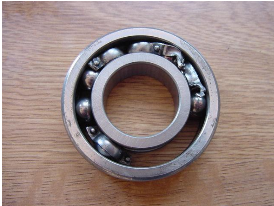
1.3.5 pav. Guolis su sulaužytu separatoriumi ir išbyrėjusiais riedėjimo kūnais.
