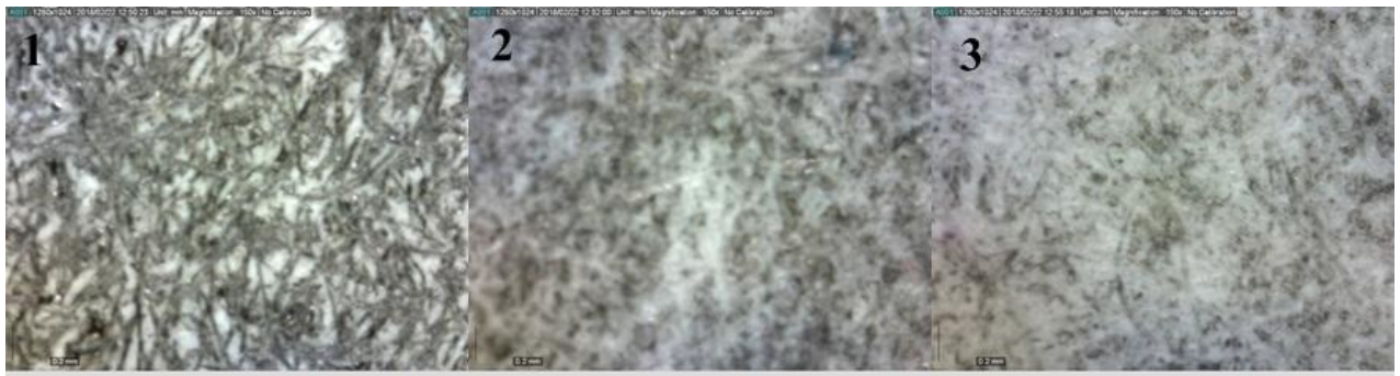
26 pav. 100 % juodos spalvos paveikslėlio elementas priartintas 150 \mu\text{m} . 1. Medvilninis popierius su spauda; 2. Rankų darbo popierius su celiulioze; 3. Rankų darbo popierius laikraščių pagrindu
