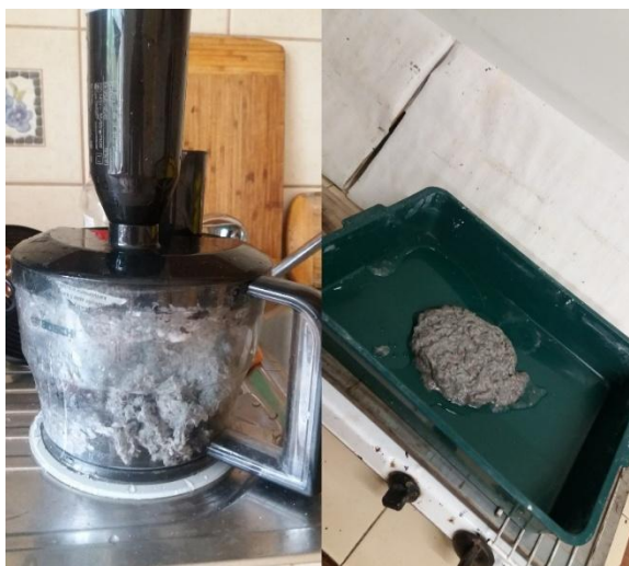
10 pav. Kairėje, permirkęs popierius trinamas trintuvu, dešinėje, paruošta masė
