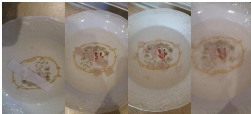
20 pav. Kairėje, biuro popierius nepakitęs visą bandymo laiką. Dešinėje, rankų darbo popieriaus irimas po 5min., 10min. ir 20 min.
