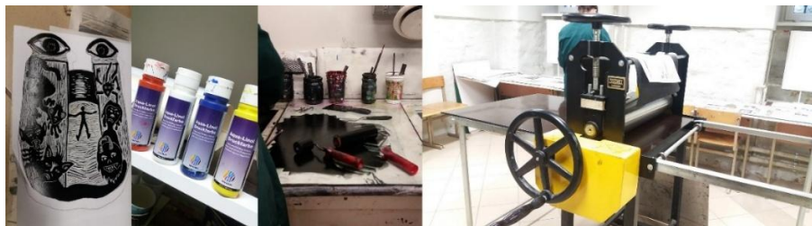
21 pav. Kairėje, lino ražinys, šalia esančioje nuotraukoje linoleumui skirti dažai vandens pagrindu, klišės padengimas dažais ir prispaudimo presas (spausdinimo staklės) per kurį važiuoja atspaudas ir dengiamoji medžiaga
