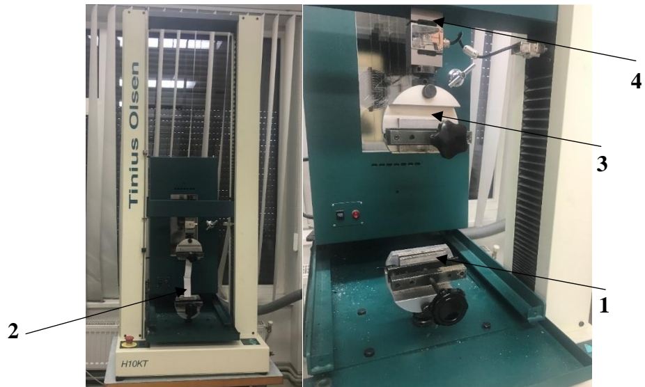
11 pav. Universalios gniuždymo - tempimo mašinos „Tinius Olsen H10KT“ tempimo dalies bendras vaizdas: 1 – nejudanti apatinė plokštė, 2 – tentinės medžiagos bandinys, 3 – judanti dalis, 4 – jutiklis
