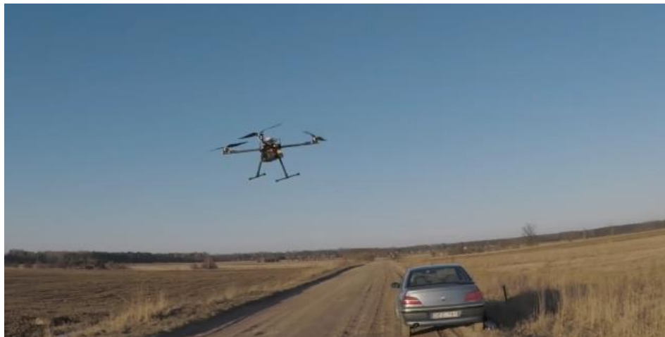
27 pav. Retransliatorius kyla į 50m aukštį skrydžio laiko bandymui
