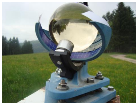
1.1.2 pav. Saulės spindėjimo trukmės matavimui naudojamas heliografas[4]
