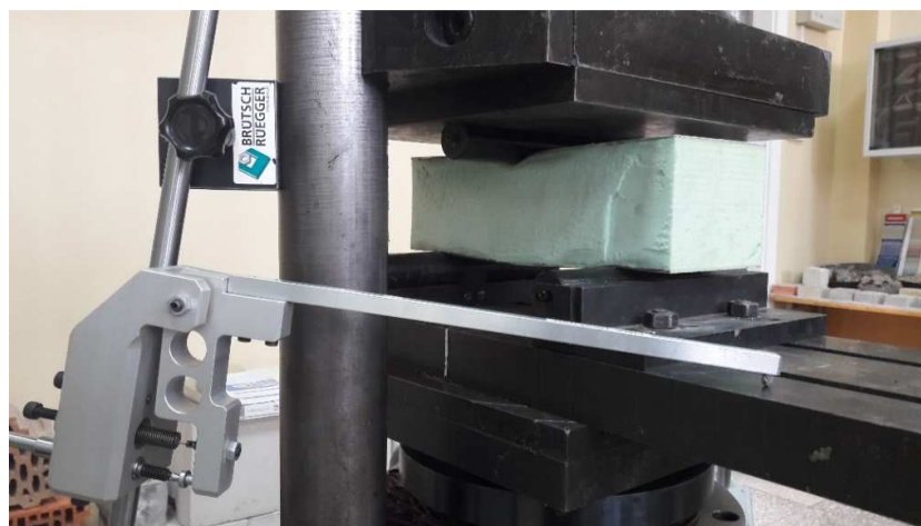
2.33 pav. Poslinkio daviklio padėtis ir bandinio užfiksavimas bei spaudimas
