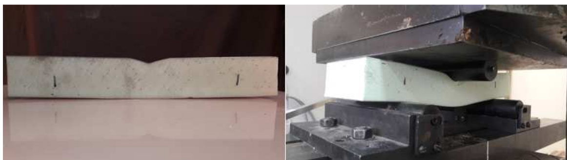
2.40 pav. 45 mm plokštės (skarda 0,6/0,6 mm) liekamoji deformacija
