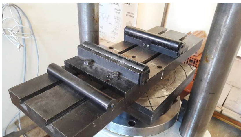
2.32 pav. Bandinio atramos lenkimui atlikti
