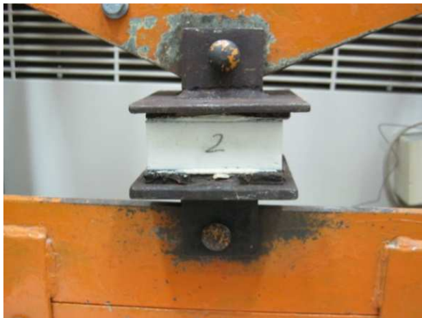
2.12 pav. Bandinio tvirtinimas tempimo staklėse
