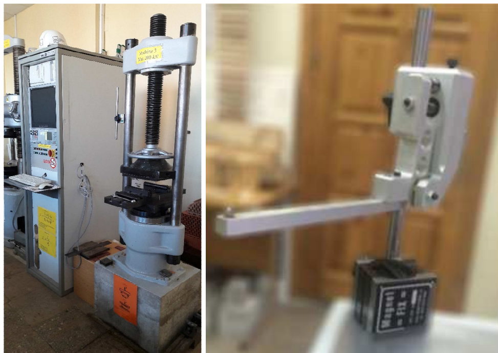
2.30 pav. Hidraulinė stotis „Walter bai“ NS-PAS su presu ir poslinkio daviklis BRÜTSCH/RÜEGGER
