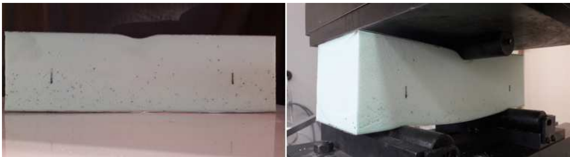
2.36 pav. 85 mm plokštės (skarda 0,4/0,4 mm) liekamoji deformacija
