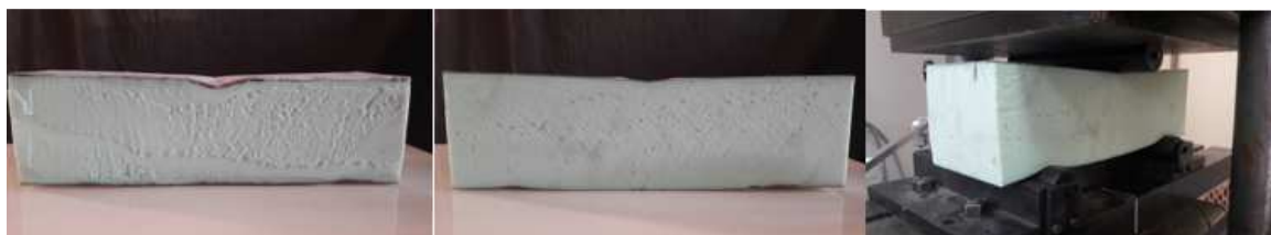
2.34 pav. 85 mm plokštės su jungimu (skarda 0,4/0,6 mm) liekamoji deformacija
