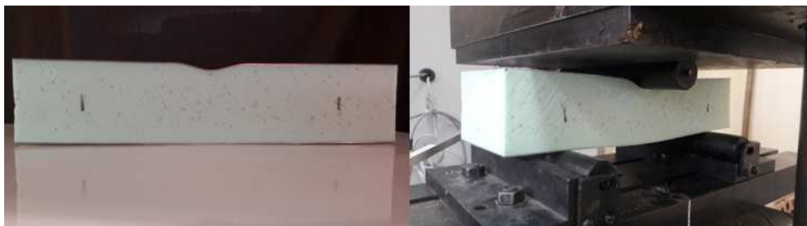
2.38 pav. 65 mm plokštės (skarda 0,6/0,6 mm) liekamoji deformacija
