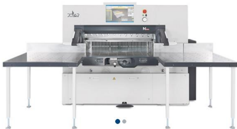
21 pav. Vienpeilė pjovimo mašina „POLAR 115 AT HD“ [19]
