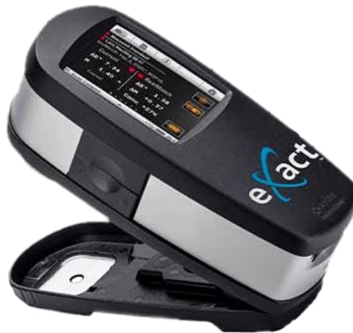
23 pav. Densitometras „X-rite eXact Densitometr“ [21]
