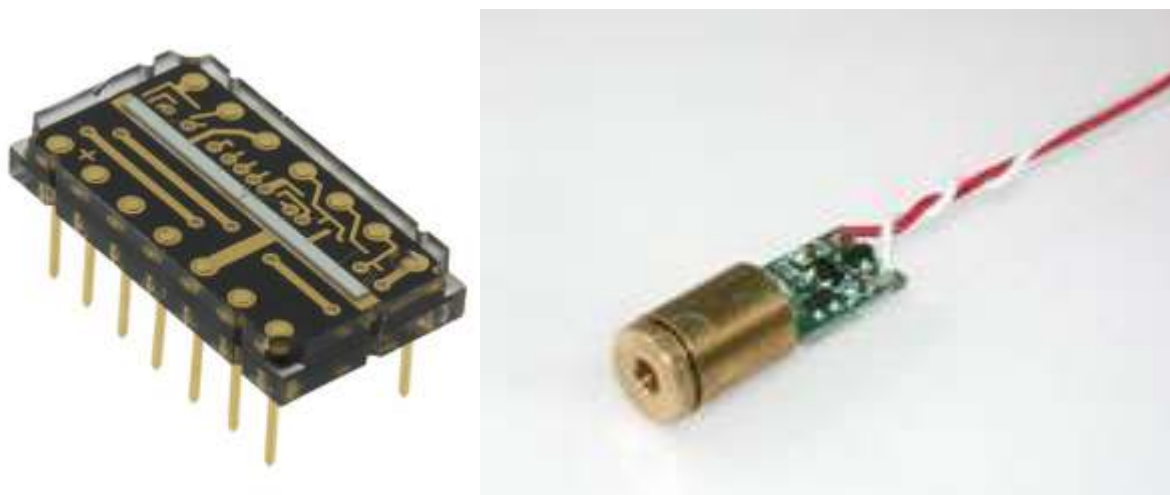
2.7 pav. Optinis masyvas TSL1402R ir lazerio modulis U-MD-650A
