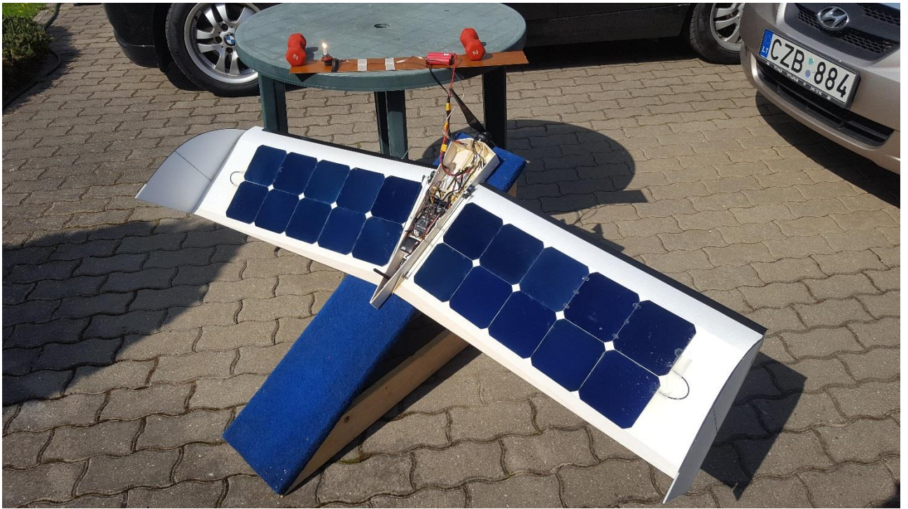
25 pav. Didžiausią efektyvumą pasiekti, orlaivis pritvirtinamas atakos kampu
