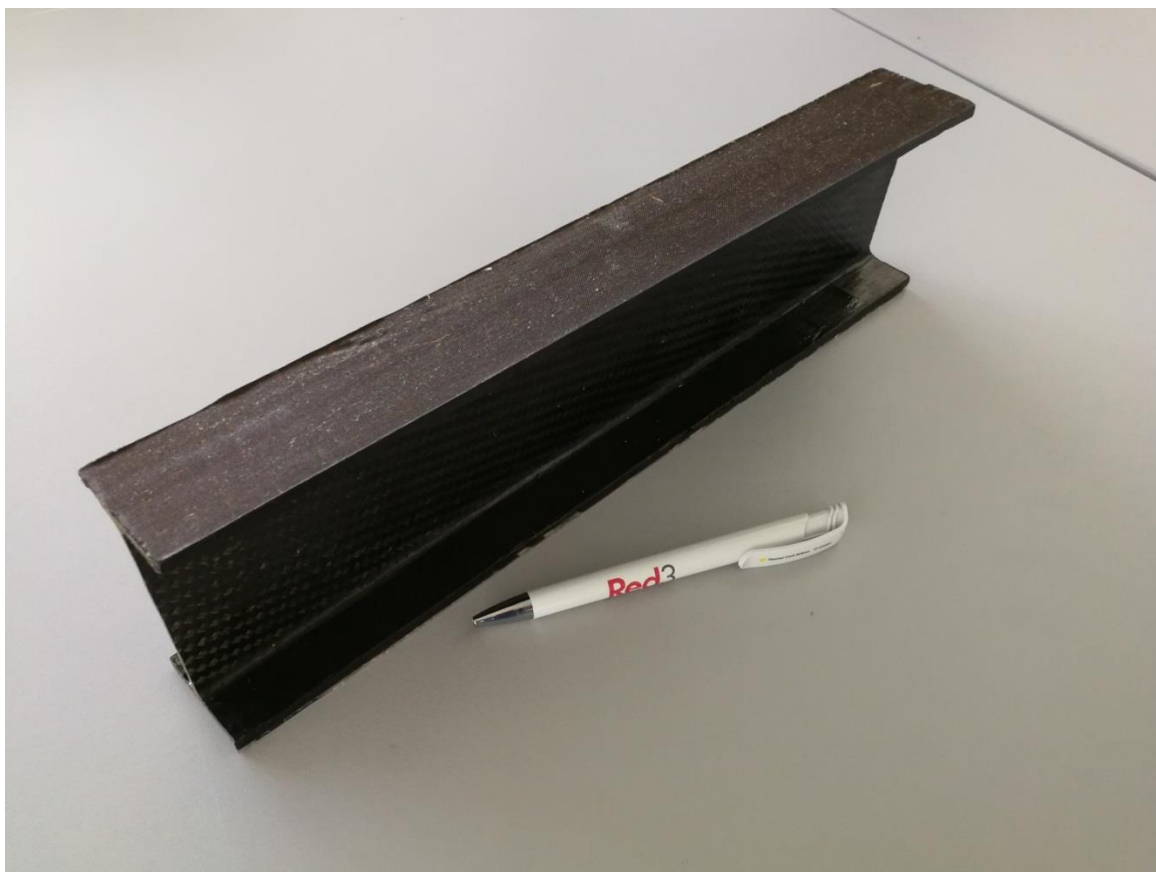
1 pav. Sklandytuvo lonžeronas pagamintas iš CFRP
