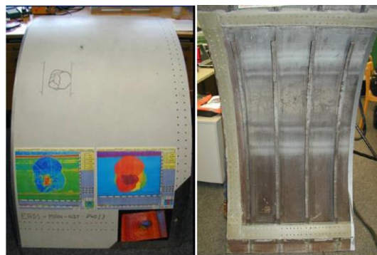
14 pav. Pavyzdys su įlenkimo pažeidimu [21]
