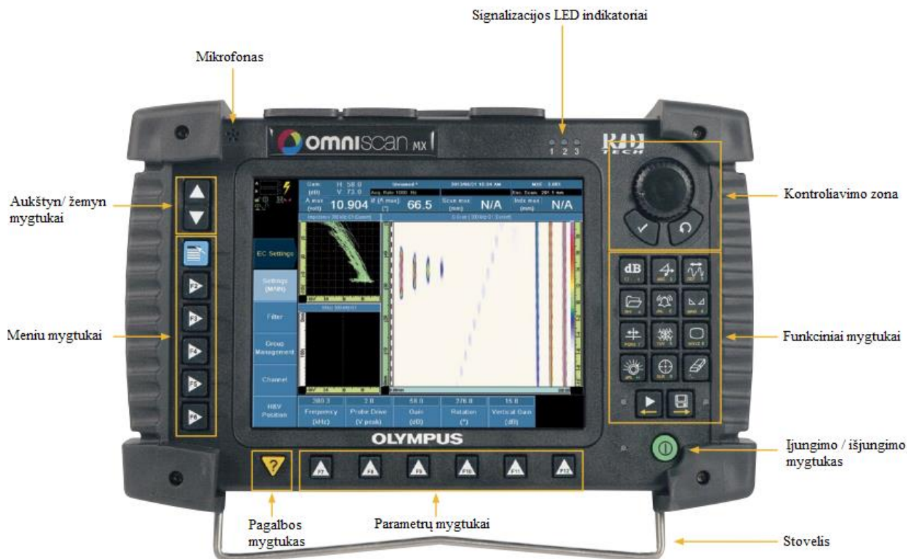
44 pav. Olympus OmniScan MX matavimo sistema [22]
