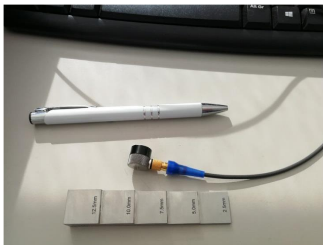
46 pav. Naudojamas keitiklis ir kalibravimo plokštelė
