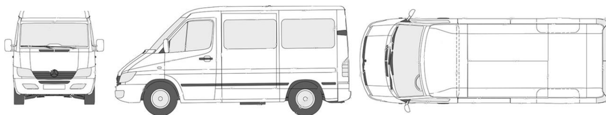
3.1pav. MB Sprinter 208 projekcinės paveikslai [15]
