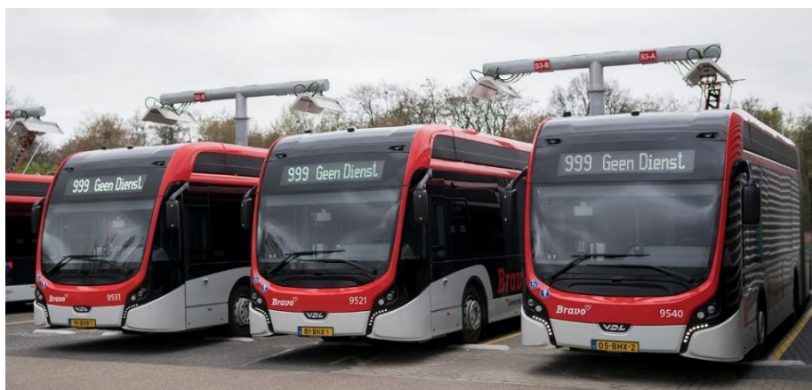
8. pav. Autobusų įkrovimas „Hermes“ autobusų depe, naudojant pantografus [20]
