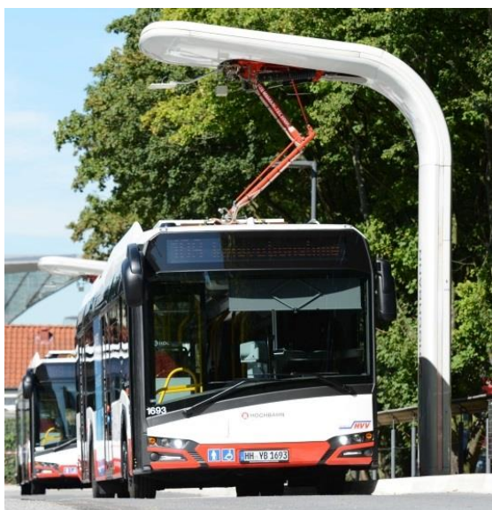
5. pav. Kontaktinio įkrovimo pavyzdžiai. Kairėje Hamburgo mieste veikianči „Siemens“ stacionari įkrovimo stotelė naudojanti pantografą [8]; Dešinėje dinaminio įkrovimo pavyzdys Švedijos greitkelyje [9]
