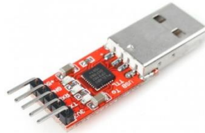
3.4 pav. CP2102 USB į TTL UART tiltas [33]
