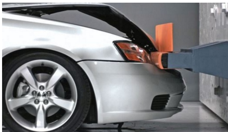
2.12 pav. Nedidelio greičio susidūrimo automobilio priekiu bandymas [20]
