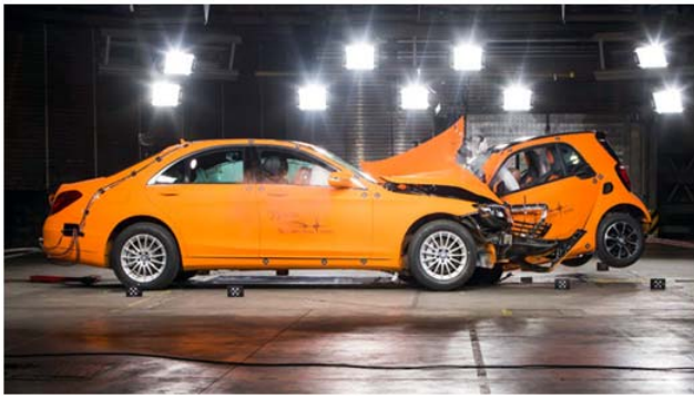
2.10 pav. „Smart“ ir „MB“ susidūrimo bandymas [18]
