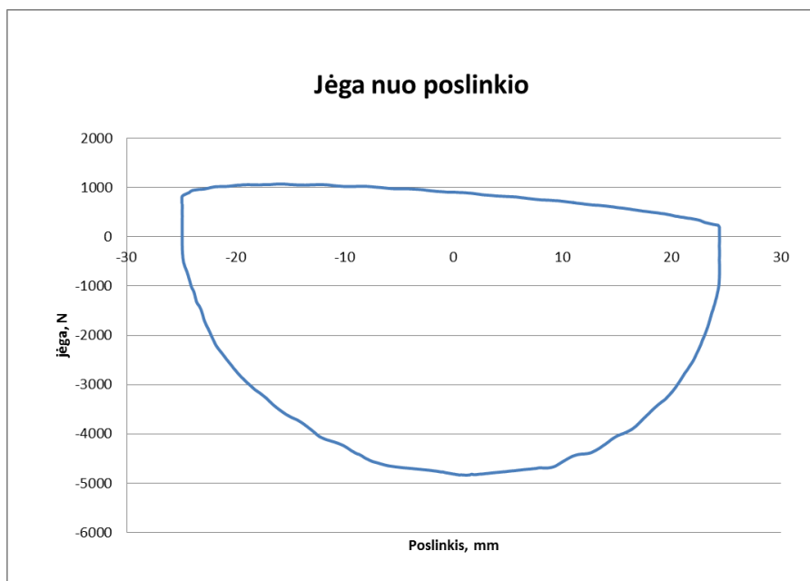
2.7. pav. Priekinio virpesių slopintuvo jėgos priklausomybė nuo poslinkio, padėtis – 32
