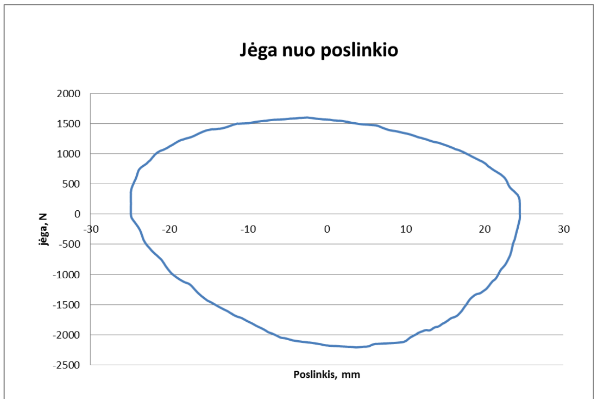
2.26. pav. Galinio virpesių slopintuvo jėgos priklausomybė nuo poslinkio, padėtis – 0
