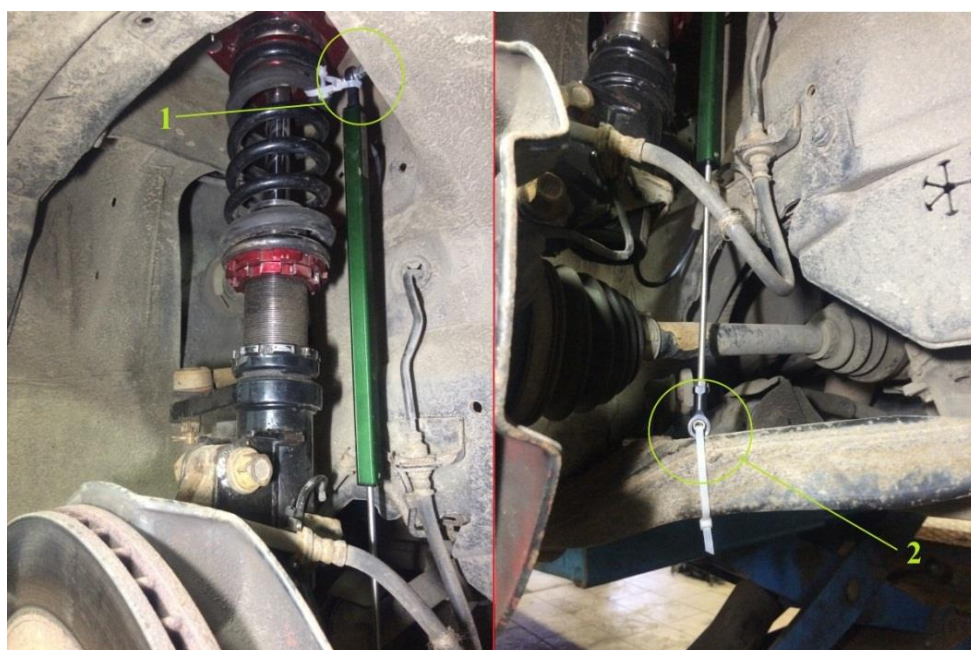
3.3. pav. Poslinkio jutiklio įtvirtinimas: 1 – viršuje; 2 – apačioje
