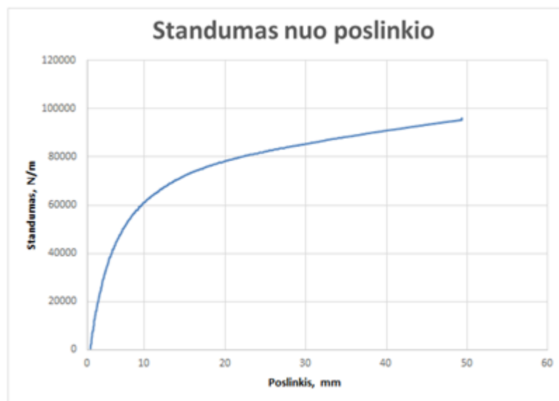
2.34. pav. Galinės spyruoklės standumo priklausomybė nuo poslinkio
