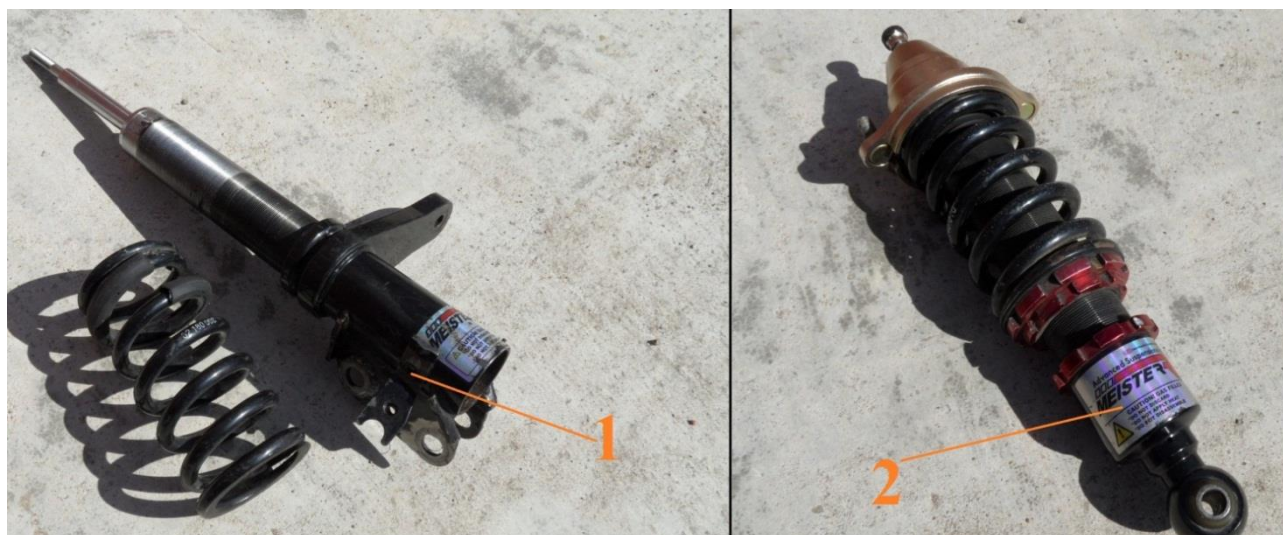
2.1. pav. „Honda Civic Type R“ virpesių slopintuvai: 1 – priekinis; 2 – galinis
