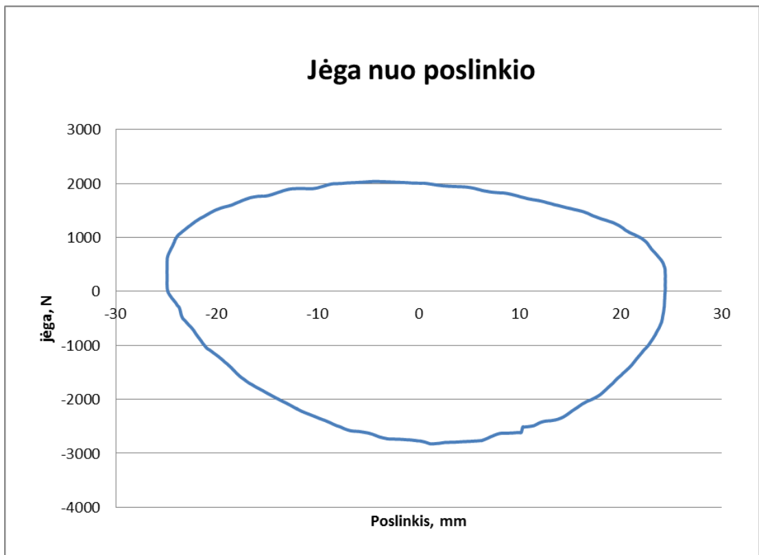
2.23. pav. Galinio virpesių slopintuvo jėgos priklausomybė nuo poslinkio, padėtis – 16
