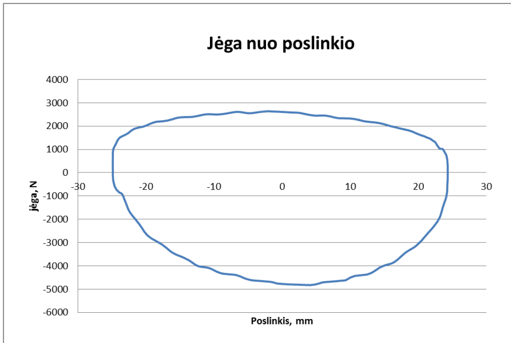
2.20. pav. Galinio virpesių slopintuvo jėgos priklausomybė nuo poslinkio, padėtis – 32
