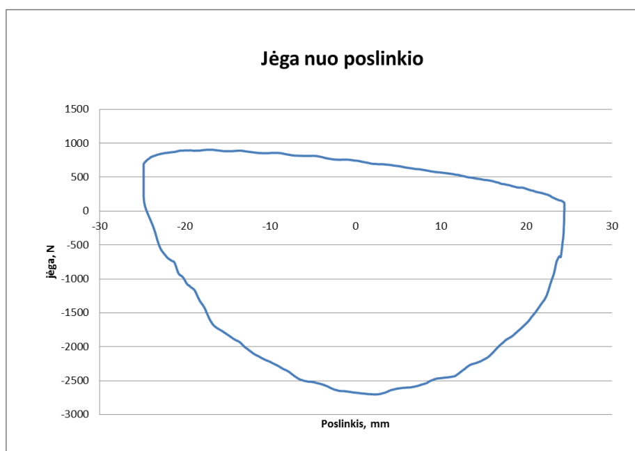
2.10. pav. Priekinio virpesių slopintuvo jėgos priklausomybė nuo poslinkio, padėtis – 16
